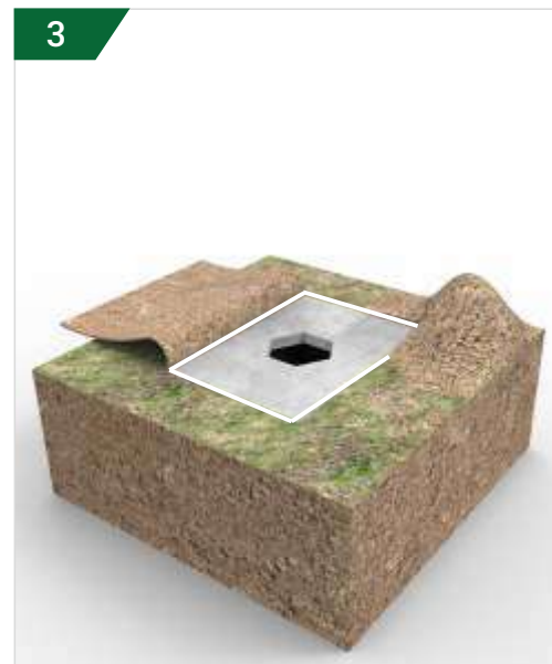
3 Фиксируем по бокам грунтом
