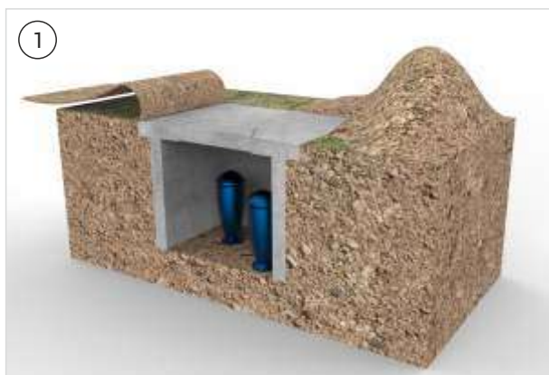
1 Копка ниши под бетонный склеп
